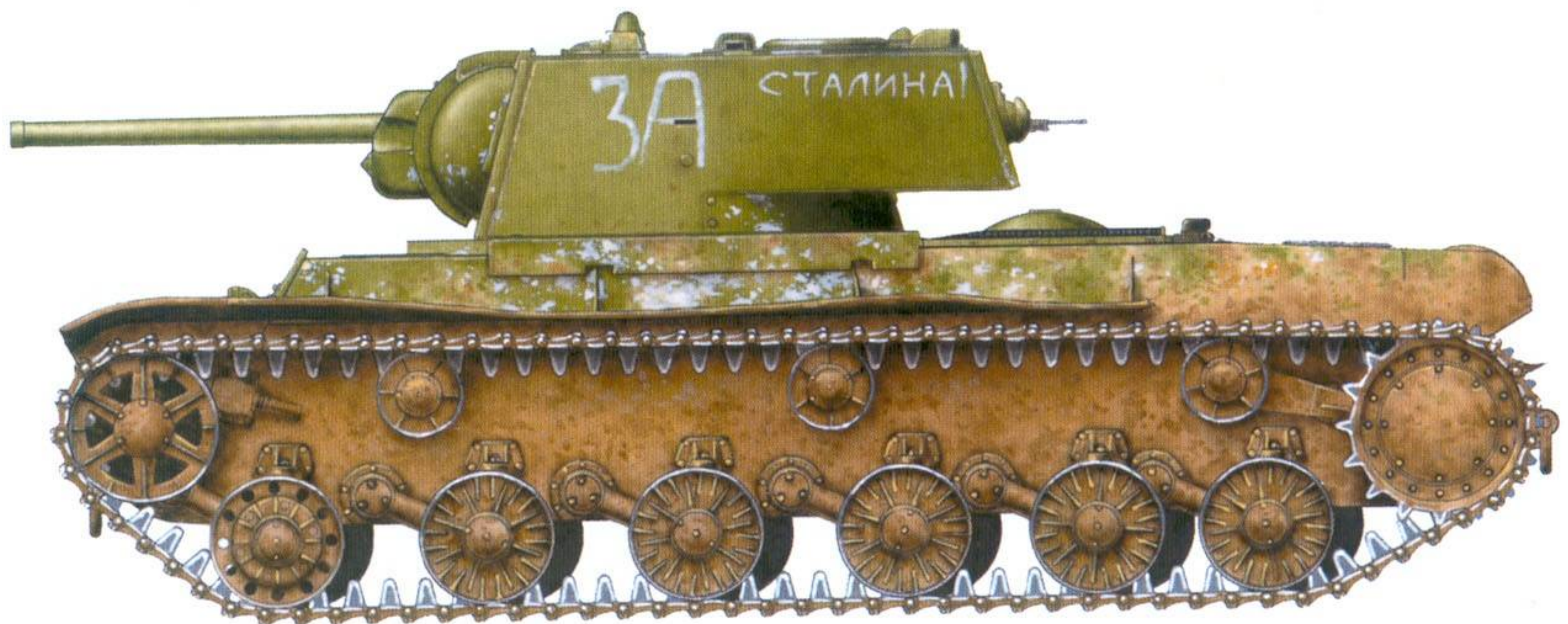
КВ-1 выпуска 1941 года со сварной башней. Надпись на башне "За Сталина". Согласно приказа Начальника штаба фронта для опознавания с воздуха на башне сверху нанесены две 15 см белые полосы. Крымский фронт, 229-й отдельный танковый батальон, 51-я армия, март 1942 года. Model 1941 KV-1 tank with welded turret. "Za Stalina!" inscription on the turret. According to the Front Chief of Staff order two 15-cm white straps are painted on the turret top for air identification. The Crime front, the 229th independent armoured battalion, 51st Army, March 1942.
